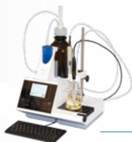
**4** Unsere Topmodelle mit Wechselaufsatz für die volumetrische und für die Karl-Fischer-Titration
