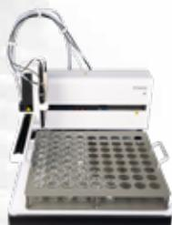
**6** Probenwechsler zur Automatisierung der Titration
